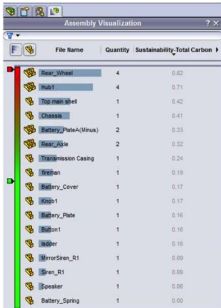
Abbildung 4: Vergleich des „Total Carbon“, also gesamte CO 2 -Äquivalente, verschiedener Materialbestandteile mit dem CAD-Softwaretool SolidWorks®
